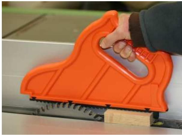
شکل ۴: کاربرد دسته مخصوص هل دادن چوب به هنگام استفاده از اره مدور
